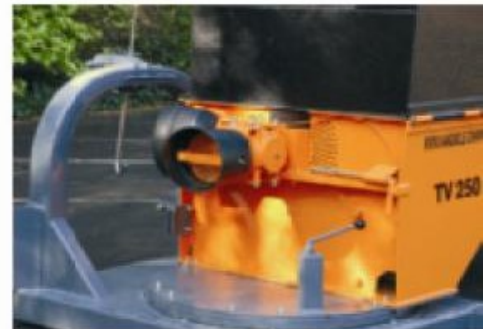
TV250 P; Driepunt gedragen machine, 2 x 90° draaibare uitvoering (optie).
