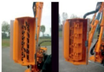
Keuze: standaard maaikop met klepels of maaikop met kooirotor voor het zwaardere werk.
