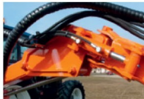
HYDRAULISCHE botsbeveiliging op de tweede arm – mechanische beveiliging op model DZ 1-30.
