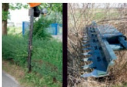
Veelzijdigheid: mogelijkheid om de arm uit te rusten met haagschaar en / of takkenschaar.
