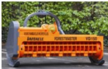
Mechanisch aangedreven 3-punts uitvoering voor tractoren.
