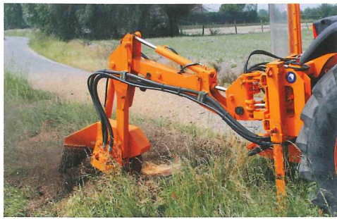
Zelfde werkingsprincipe als een mini graafarm.
