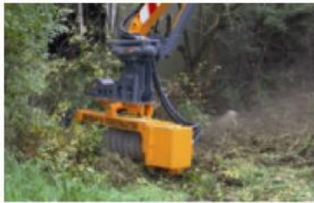
Hydraulisch aangedreven model voor opbouw op maaiaarm of kraanarm.
