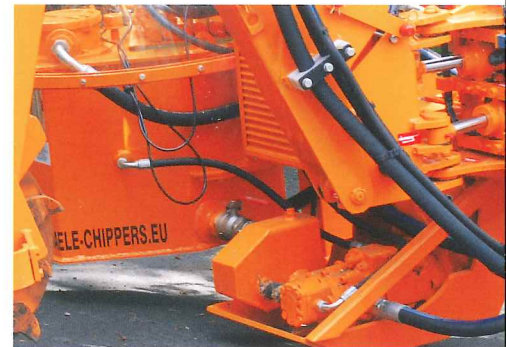
Geïntegreerd hydraulisch circuit: pompen, olietank, oliekoeler.
