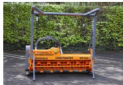
Mechanisch verstelbaar bomenrek met versterkte maaikast (optie).
