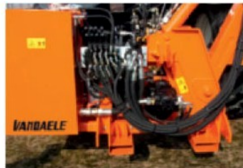
Hydraulisch systeem ingebouwd: olietank, dubbele pomp, verdeelblok.
