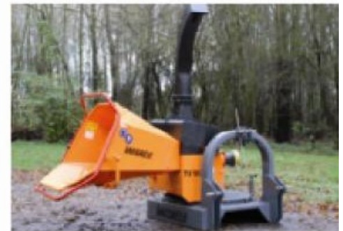
TVI 180 P ; Tractor aangedreven 2 x 90° draaibaar (optie)
