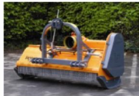
Cilinder voor hydraulisch zijdelings verstek (optie).
