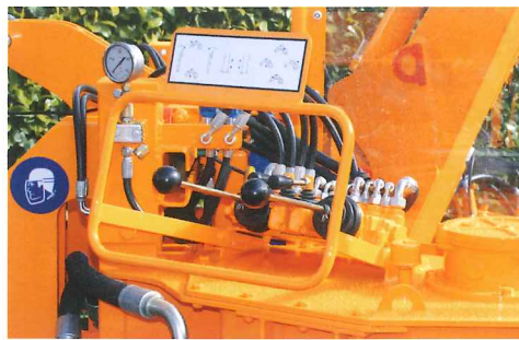
Standaard voorzien van kruishendel besturing op zijkant van de machine.
