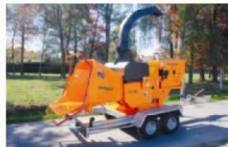
Motor aangedreven op onderstel snelvervoer
