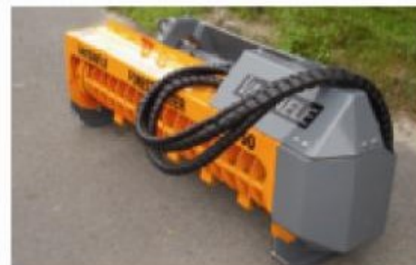
Hydraulisch aangedreven versie voor werktuigdragers.
