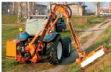
Standaard 3-punts uitvoering voor achteraan de tractor; optioneel aanbouw vooraan op 3-punt.
