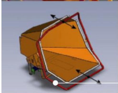
Optimale veiligheid voor de gebruiker door rondom beugel beveiliging (patent VANDAELE® N° 2003/0590)
